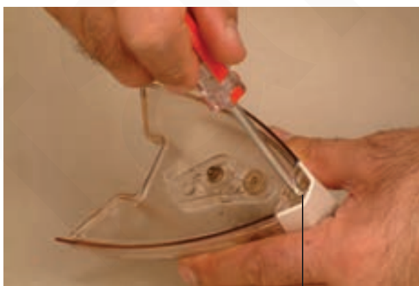
پیچ محکم‌کننده‌ی قاب پلاستیکی به بدنه‌ی مخزن
